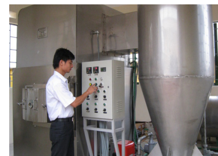
Lò đốt chất thải rắn VHI-18B để xử lý chất thải rắn nguy hại y tế và công nghiệp được ứng dụng rộng rãi
